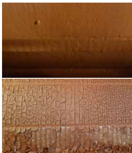
Au-dessus : Boue mouillée au début de la rotation du tambour.
